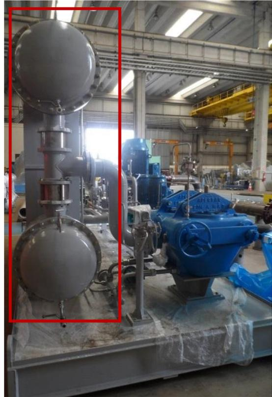
Figura 6 – Vasos de pressão de sistema de lubrificação de turbinas a vapor, fornecido com *skid* independente
